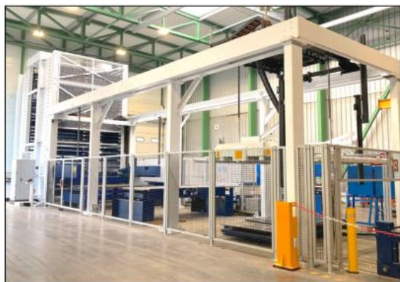
À gauche : le nouveau centre de découpe laser de 6 kilowatts, entièrement automatisé. À droite, un des deux nouveaux robots de soudure. Au centre, le nouveau magasin de stockage, lui aussi, entièrement automatisé avec au 1 er plan, un des 17 chariots robotisés utilisés pour transporter les pièces. Imprimé depuis Calameo.com lequel consiste à acheminer les pièces demandées jusqu'au préparateur à l'origine de la commande.
